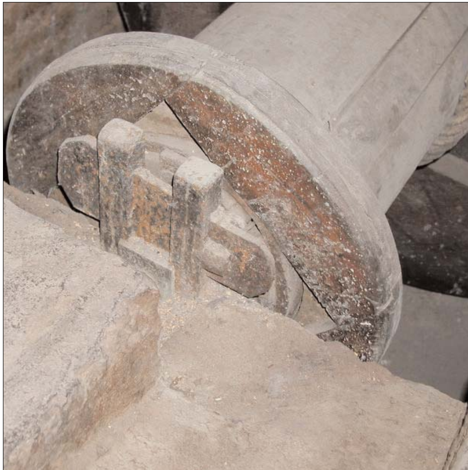
Figura 11. Vista del gruppo di pulegge con i roccetti di diametro differente; si può notare la fune semplice ancorata al roccetto di diametro maggiore e le funi a trefoli agganciate ai roccetti di diametro minore.
