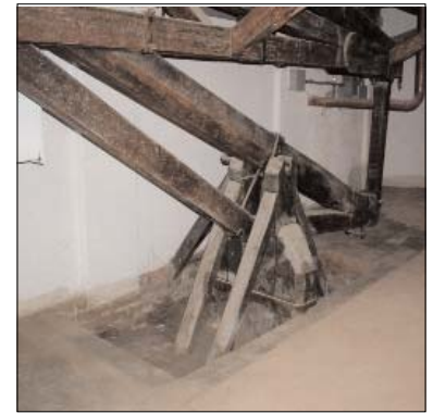
Figura 14. Vista della leva di sollevamento in configurazione di riposo ossia con il braccio lungo sollevato. A differenza dell'altra coppia di leve il supporto non presenta contrafforti ed è alloggiato in un vano incassato nel pavimento.
