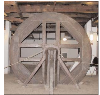
Figura 8. Vista della ruota oziosa, del suo parziale alloggiamento in un vano interrato (accorgimento necessario per evitare interferenze con l'intradosso dell'impalcato di platea) e del supporto che ne consente la rotazione.
