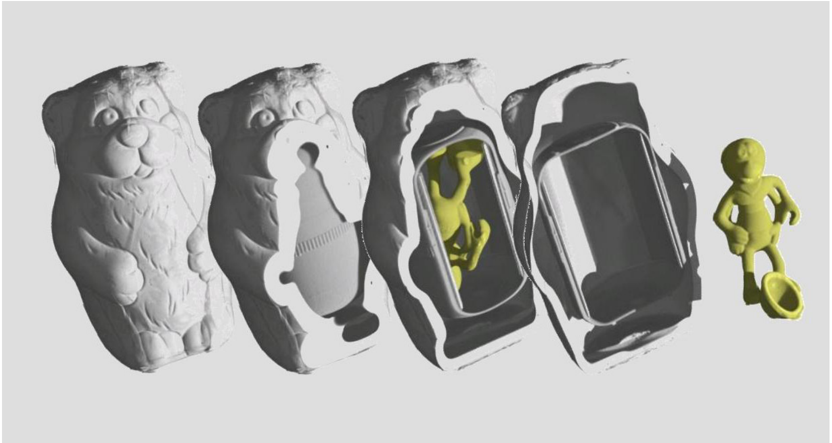
Fig. 6. Separazione regioni di volume di materiale differente.
