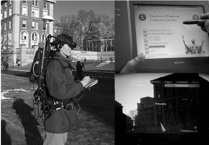
7. Uno dei primi dispositivi mobili per la realtà aumentata: il *Touring Machine* per il sistema MARS, 1997, Columbia University, durante una sperimentazione all'interno del Campus.
