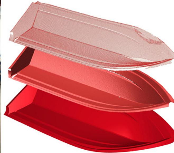
8. Acquisizione e modellazione tridimensionale dello scafo di un gommone (Nautica CAB). Dal modello fisico alla nuvola di punti allineata, modello poligonale e ricostruzione per superfici matematiche.
