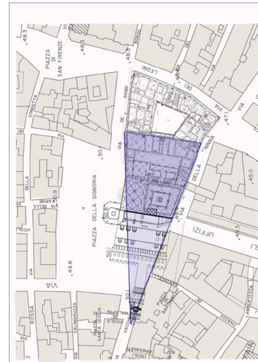
Fig. 7 - Il triangolo nello stargo di via Vacchereccia, dove si può pensare la stazione topografica del tracciamento.
