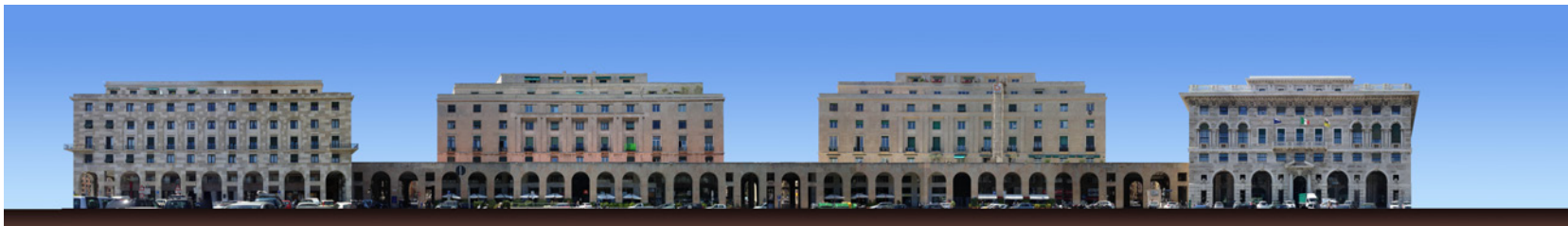
Fig. 4_Piazza della Vittoria lato Nord, raddrizzamento geometrico relativo ai prospetti. Rilievi fotografici ed elaborazioni digitali, realizzate con software Perspective Rectifier, del civ. 15 e del civ. 1 di Michela Mazzucchelli. Elaborazioni digitali dei blocchi centrali (edifici detti Jacazio e Garbarino) di Massimo Malagugini.
