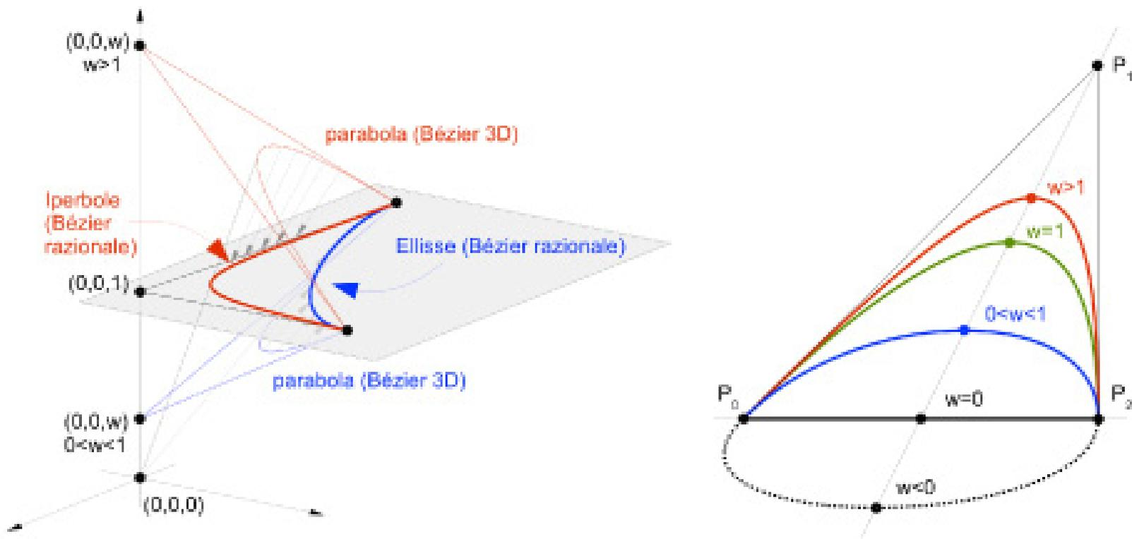
Figura 8. Curve di Bézier razionali. A sinistra: le sezioni coniche ottenute da una parabola; a destra: l'effetto del peso  $w$  relativo a  $P_1$
