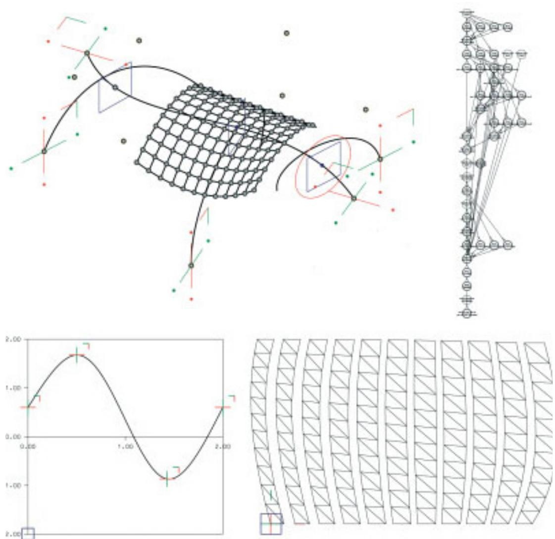
Figura 4. Dalla rappresentazione alla generazione della forma: il modello geometrico, il modello simbolico della stessa geometria sottoforma di grafo, la curva di controllo, il modello delle componenti elementari (Robert Aish, Bentley Systems).
