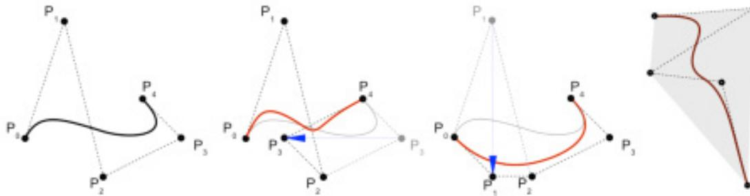
Figura 6. Proprietà geometriche. A sinistra: spostare un punto modifica tutta la curva. A destra: la curva “vive” nell’involuppo convesso dei suoi punti di controllo
