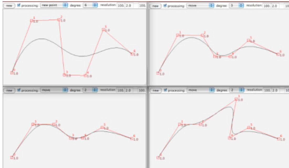
Figura 7. Una curva di Bézier di grado 6 al confronto con B-splines di gradi 3 (formata da 4 pezzi) e 2 (5 pezzi) di aspetto del tutto similare; si noti anche il comportamento locale
