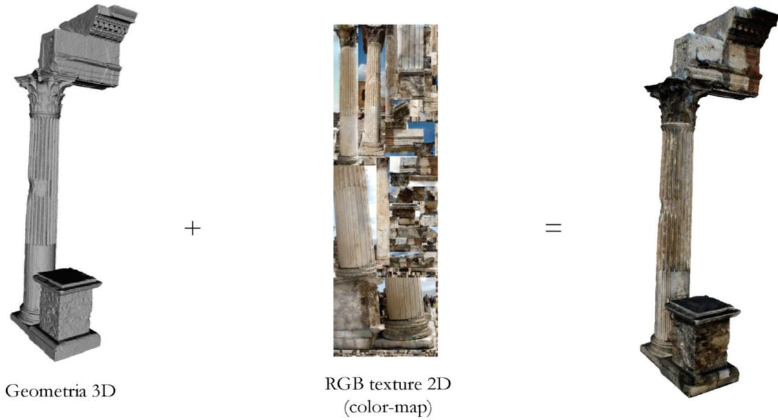
Figura 5. Linee guida per un Sistema Informativo 3D GIS della SSBANP. Formazione di modelli 3D reality-based: mappatura di texture su primitive geometriche.
