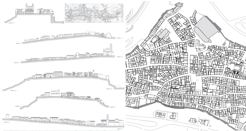
Figura 4. Morfologia urbana del centro storico di Camerino. A sinistra: il rapporto tra il costruito e il sito. A destra: planimetria dei piani terra. Stralci, originali in scala 1:500.
