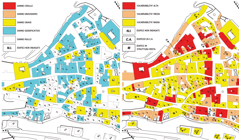
Figura 3. Mappatura per l'intero centro storico dei valori accertati di danno per unità di edificio, a sinistra, e dei valori di vulnerabilità presunta per unità di edificio, a destra. Stralci, originali in scala 1:2000.
