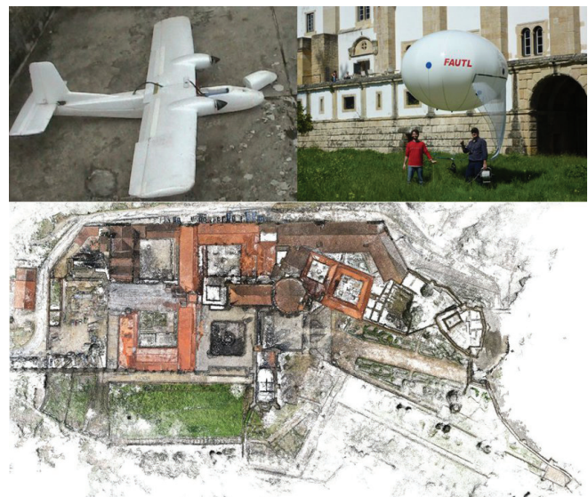
Figura 5. Em cima: Plataformas aéreas de baixa altitude. Em baixo: Orto-imagem do modelo de nuvens de pontos gerado por fotogrametria automática.
