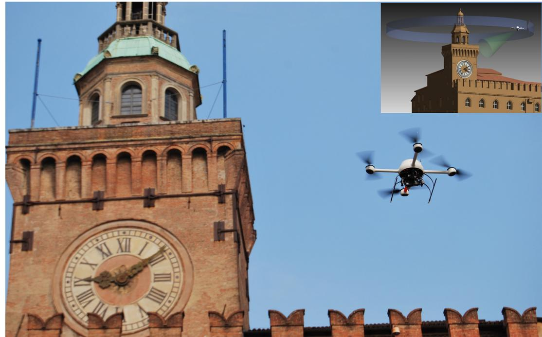
Figura 4. Strumenti di rilievo fotografico e fotogrammetrico di prossimità mediante quadricottero Microdrones MD4-200. Il drone di tipo UAV (*Unmanned Aerial Vehicle*) è stato utilizzato per le riprese in quota di Piazza Maggiore a Bologna e della torre dell’orologio di Palazzo d’Accursio (riquadro in alto a destra), per la quale sono stati condotti test di fedeltà metrica (giugno 2011). Si ringrazia in tal senso la società Eye-Sky di Bologna per la disponibilità e il supporto nella ricerca.
