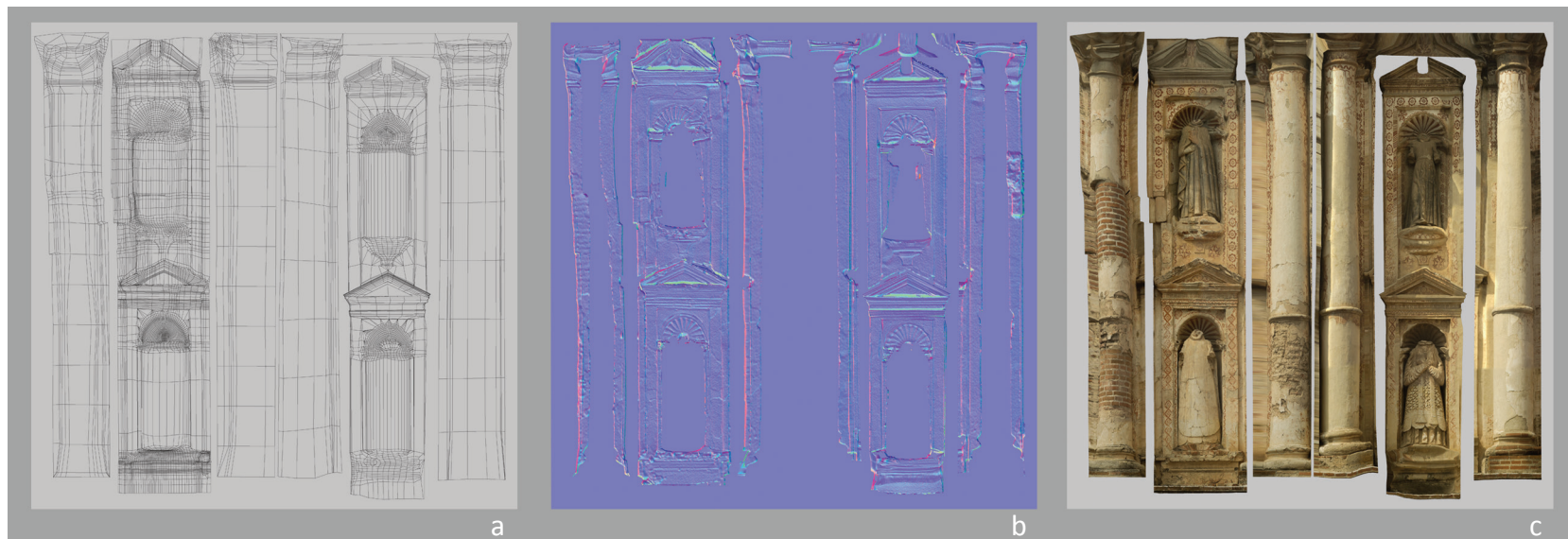
7. (a) Parametrizzazione di una porzione del modello in UV map e relativa normal map calcolata con processi di baking (b). Diffuse color map calcolata attraverso proiezione sul modello del fotogramma e successivo baking (c). I processi di baking consentono infatti di codificare informazioni di varia natura in accordo al sistema di riferimento della mappa UV.
