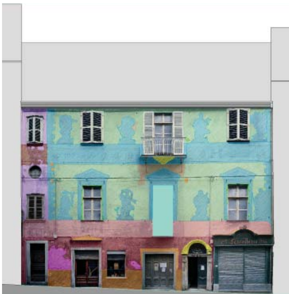
12. Mappa dei materiali, degli elementi, delle lavorazioni e delle operazioni: tinte e malte.
